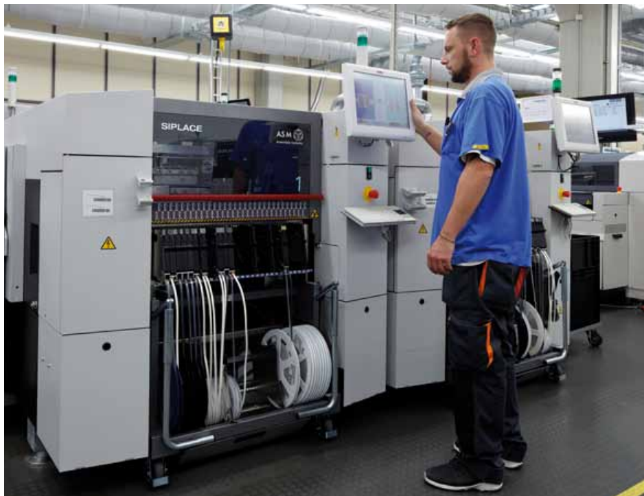
SIPLACE SX- Maschinen zur Bestückung von 01005-Bauteilen sind gleich zwei Mal im Einsatz
