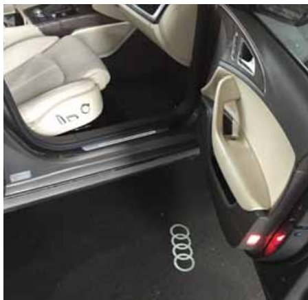
Der Tür-Beam projiziert bei geöffneter Autotür das Logo auf den Boden
